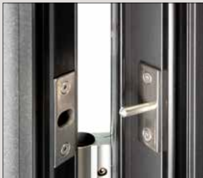
2 Bolzensicherungen im oberen und unteren Bereich verhindern das Ausheln des Türflügels (Einbruchschutz)
